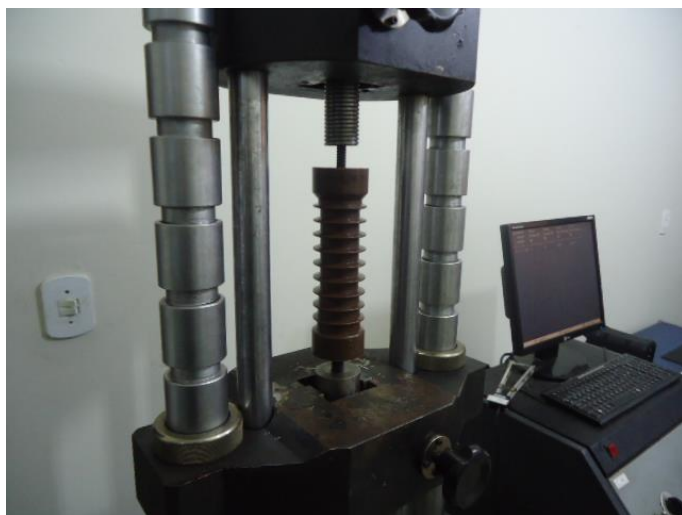
Montagem para ensaio de tração
